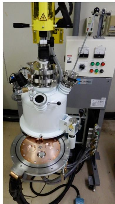
図1. 汎用型真空アーク溶解装置（大亜真空製、型番：ACM-S14TMP-M）。
